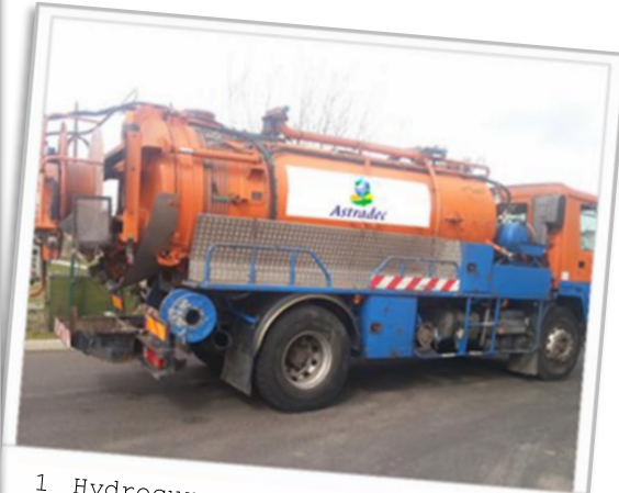
1 Hydrocureur HUWER de 8 m 3 de citerne + 1 m 3 d'eau pour HP 170 bars avec paroi mobile sur châssis VOLVO 19 tonnes - Année 1997.
