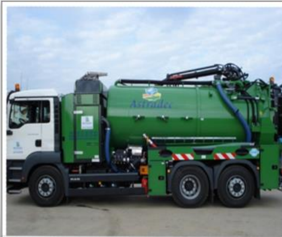
1 Hydrocureur RIVARD Type MISTRAL de 10 m 3 de citerne + 1 m 3 d'eau pour HP 190 bars avec paroi mobile et tourelle d'aspiration sur châssis MAN TG 26 tonnes - Année 2008.
