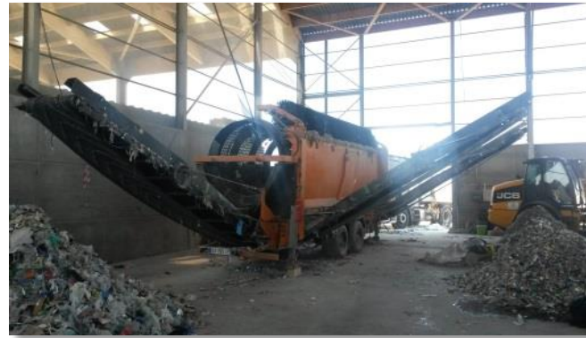
Crible rotatif DOOPSTAADT SM-818
