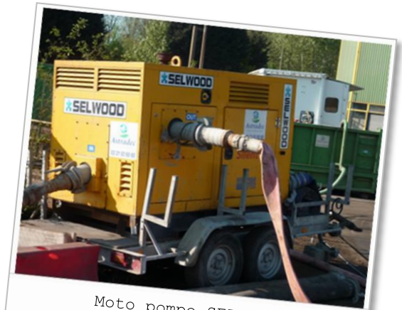
Moto pompe SELWOOD, moteur diesel
