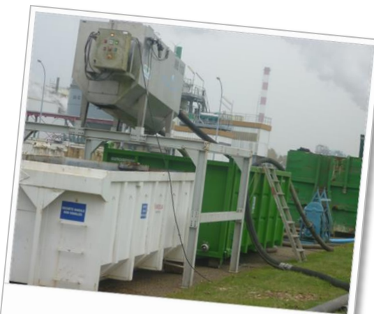
Benne étanche 20m 3 , avec trommel rotatif.
