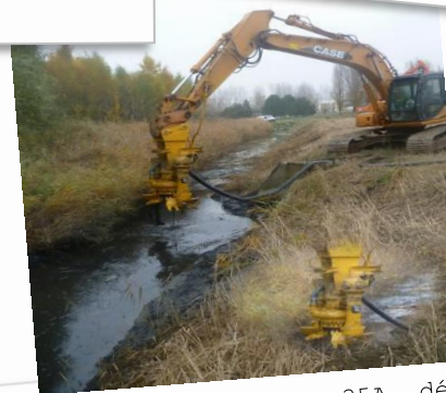
Pompe hydraulique HY 35A, débit 100-120m 3 , spécial application sable.
