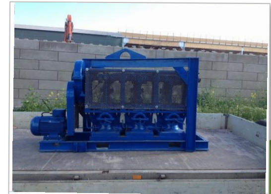
Dia pompe à membrane, moteur ATEX, utilisation dans des zones à atmosphère explosive
